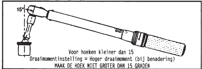
Fig. 6 – Het gebruik van slingerverloopstukken / universeelstukken voor momentsleutels.
