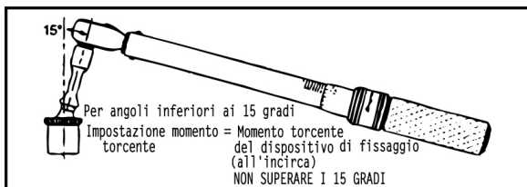
Fig. 6 – Uso di prolunghe/dispositivi universali inclinati con chiavi torsiometriche.
