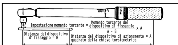
Fig. 9 – La coppia di fissaggio è inferiore al quadrato della coppia di trasmissione della chiave torsiometrica.
