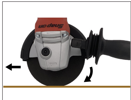
Figure 12: Tronçonnage avec un disque abrasif
